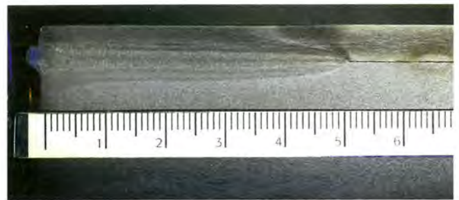
Bild 6: Makroschliff, 50 mm Einschweißtiefe, oben 6 mm Hardox unten S355
